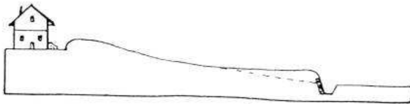
Principe du saut de loup en architecture (clôture invisible pour qui se trouve à l'intérieur)
